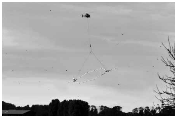
Een bijzonder vliegend object vloog eind september boven onze dorpen. Op deze manier werden kleilagen in beeld gebracht die het grondwater beschermen en wordt gemeten waar zich zoet en zout grondwater bevindt. (foto Sieb-Klaas Iwema)
