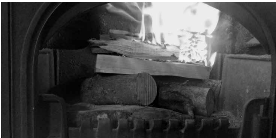
De Zwitserse methode: door het hout op een speciale manier te schikken wordt de trek in de schoorsteen rustig opgebouwd (foto Kees Zoethout)
